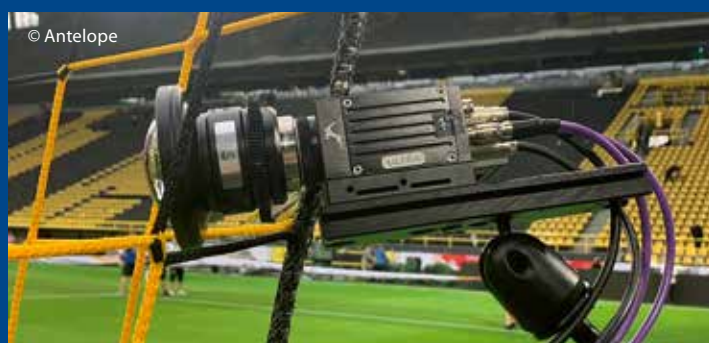
Die Antelope Ultra, hier im Tor eingesetzt, wiegt 340 g und misst 47x47x120 mm.
